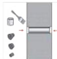
L'étanchéité à l'eau des trous de tirants est créée en utilisant des systèmes à base d'entretoise en béton fibré et d'embouts ou capots, rebouchées ensuite par des obturateurs ou des cônes de fermeture, qui sont collés.
