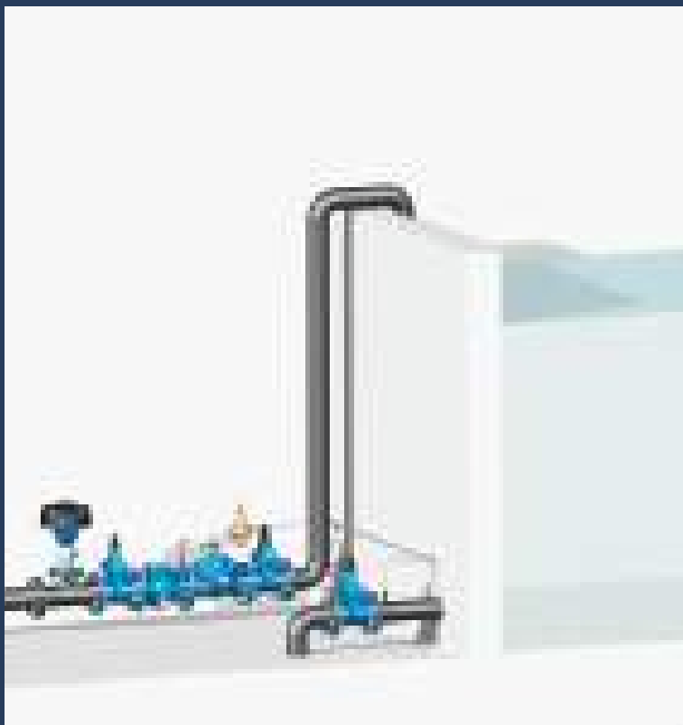
Contrôle de niveau altimétrique
